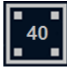
Abbildung 7 «Restriktivste überwachte Geschwindigkeit innerhalb der MA» in der Betriebsart LS, hier 40 km/h
