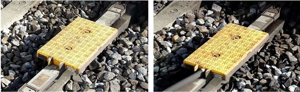
Abbildung 2 Festdaten- und Transparentdatenbalise (von links nach rechts)
