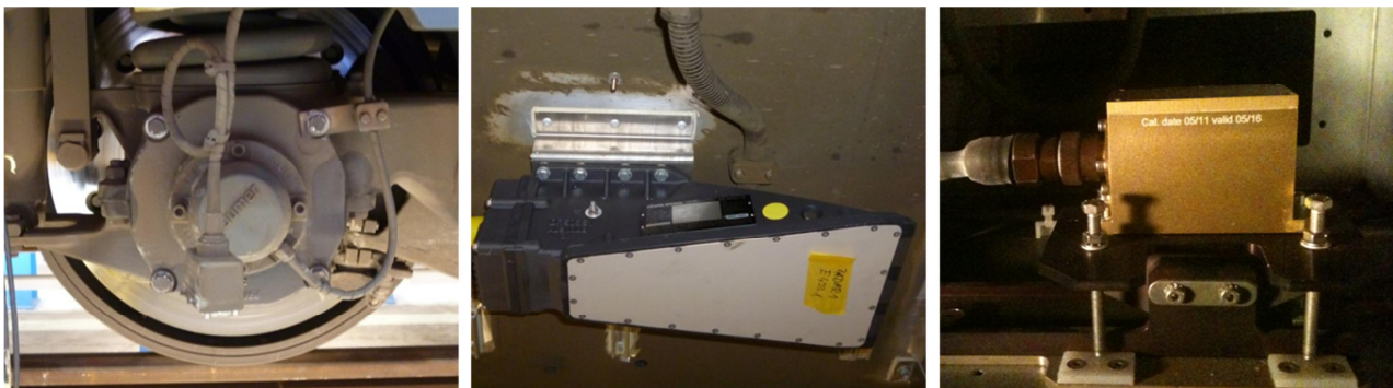
Abbildung 5 Odometriesensoren: Achsgeber, Radar-Sensor und Accelerometer (von links nach rechts).
