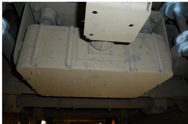
Abbildung 3 ETCS-Balisenantenne.
